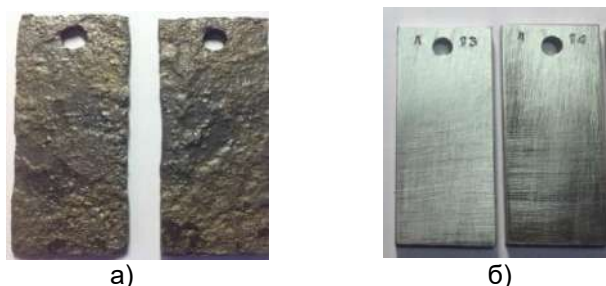
Рисунок 1 – Внешний вид образцов из стали 09Г2С а) и алюминиевого сплава 1565ч б) после коррозионных испытаний в увлажненной технической сере в течение 90 суток
