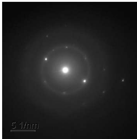
Рисунок 8 – Микродифракция от области 7 (аустенит)
