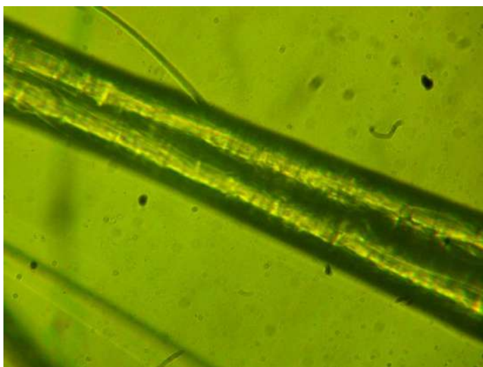
Рисунок 1 – Два параллельных сцинтилляционных микроволокна с отчетливо выраженной модуляцией внутренней структуры, которая обеспечивает распределенную обратную связь вдоль волокна и за счет этого способна увеличить световыход сцинтилляций в продольном направлении
