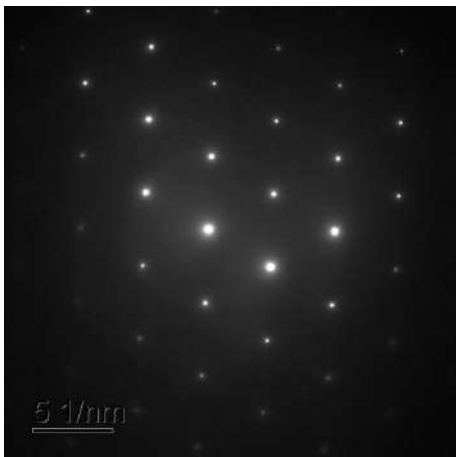
Рисунок 7 – Микродифракция от области 2 (аустенит)
