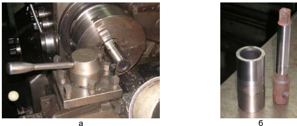
Рисунок 4 – Проведение испытаний режущего инструмента (а); внешний вид заготовок после испытаний (б)
